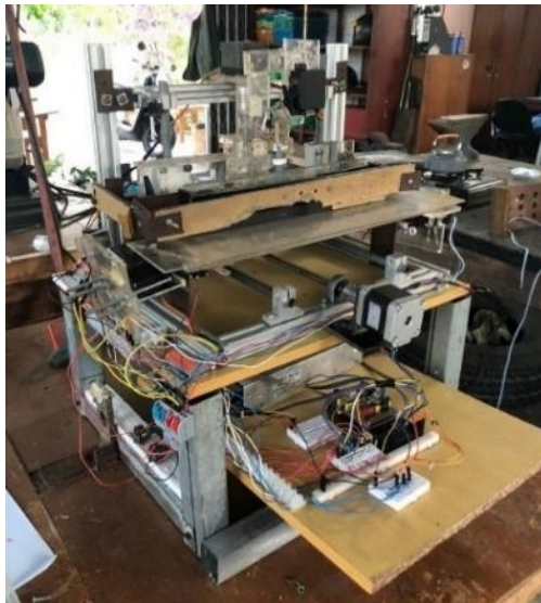
Gambar 2. Prototipe Alat Semai Otomatis Tanaman Pakcoy Pada Media Tanam Rockwool
