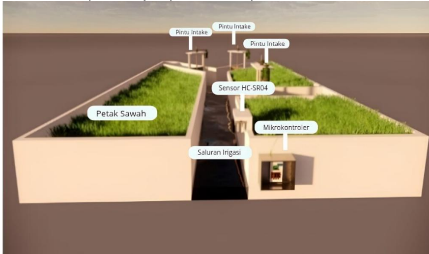
Gambar 1. Desain Pintu Irigasi Berbasis Mikrokontroler dan IOT
