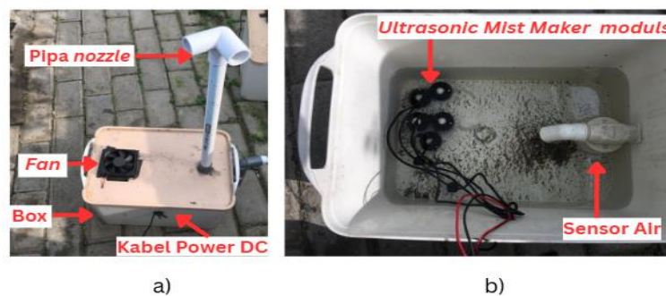
Gambar 2. Ultrasonic mist maker generator sebagai evaporative cooler a).bagian luar dan b). bagian dalam.
